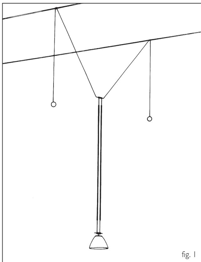
Appendere l'elemento luminoso ai cavi del sistema YaYaHo e avvolgere i cavi dell'elemento una volta intorno ai cavi conduttori. (fig. 1)
