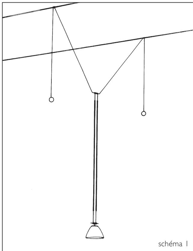
Faire pendre l'élément lumineux entre les câbles de votre système YaYaHo et enrouler les câbles avec les contre-poids autour des câbles conducteurs. (schéma 1)
