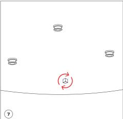
ATTENZIONE: suggeriamo di connettere la tensione di alimentazione 24V prima di posizionare i pendenti, così da verificarne immediatamente il funzionamento.
