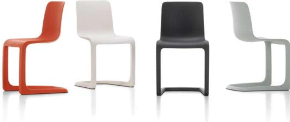
Mit EVO-C ist es gelungen, das Prinzip und die Merkmale des klassischen Freischwingers kompromisslos in Kunststoff zu übersetzen. Das Gasinnendruckverfahren beim Spritzgiessen von Kunststoffen macht es heute möglich, die Festigkeit von bewährten Stahlrohr-Freischwingerkonstruktionen zu erreichen. Die tragende Struktur wird dabei durch Hohlkörper mit Rohreigenschaften gebildet, und die flächigen Geometrien von Sitz und Rücken können fließend und nahtlos daran angeschlossen werden.
